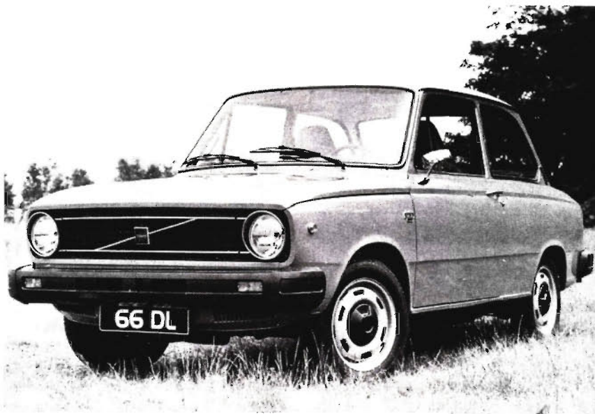
Der Volvo 66 DL mit 45-PS-Motor besitzt wie die übrigen Versionen dieser Baureihe kräftige und gummibelegte Stoßfänger. Die Türgriffe wurden gegenüber denen des Vorläufers verbessert, der Außenspiegel erneuert Werkfoto
