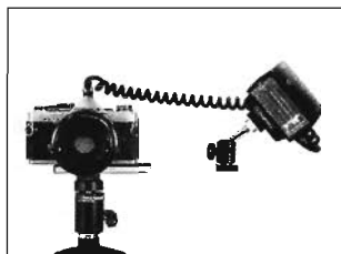
Abbildungen 1 bis 3: Geräteanordnungen – Olympus OM-2N mit einem T32 und OM-4 mit zwei T32 Blitzlichtgeräten
