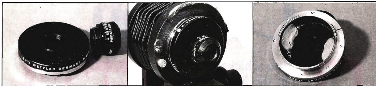
Oben links: Objektivträgerplatte mit Leitz Photar 4/50. Oben Mitte: Objektiv mit Trägerplatte in das Leitz-Balgengerät eingesetzt. Oben rechts: In die Rückseite der Objektivträgerplatte ist ein Polarisator eingelegt und Mineralienkitt fixiert
