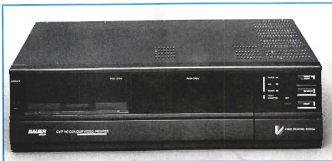
Liefert farbige Sofortbilder ( 77 \times 97 mm) vom Videoband, von einer angeschlossenen Videokamera oder vom Fernsehschirmbild
