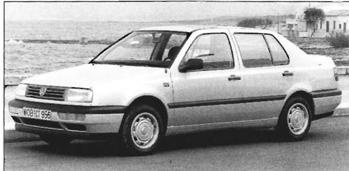
Die sechs Varianten des Vento verfügen u. a. serienmäßig über Fünfganggetriebe, Servolenkung und einen Staub- und Pollenfilter. Der vorn quer montierte Motor ermöglicht eine kurze Motorhaube, die durch die abfallende Form sehr gute Sicht auf die Fahrbahn freigibt. Unser Bild zeigt die preisgünstige CL-Variante. Werkfoto
